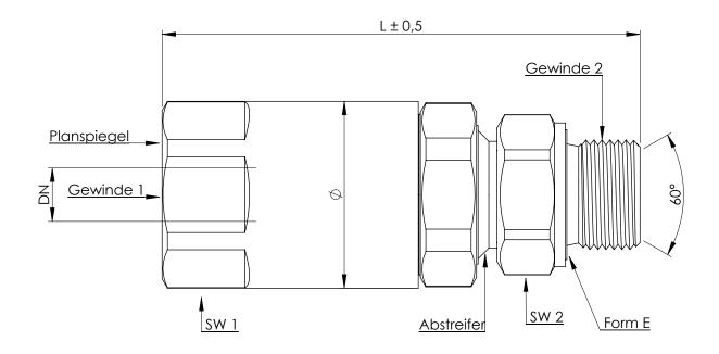
Stahlteile Oberfl. Zn - Ni Achse Stahl unbehandelt Gewindebuchse mit IGUS - Gleitlager GSM Axial Kugellager für geringes Drehmoment
